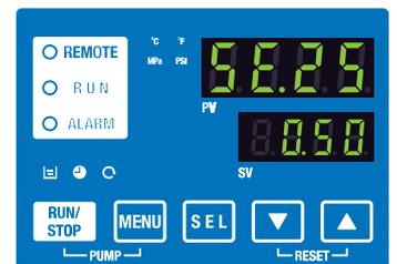
操作面板(循环液输出压力设定画面)
