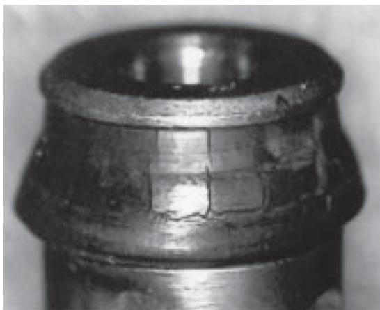
照片2 单向阀密封圈的龟裂
