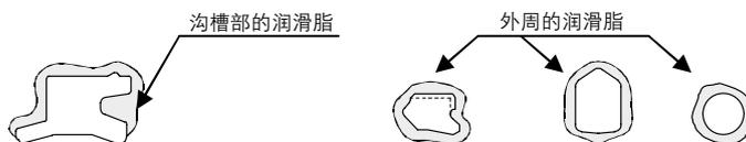
图3 向密封圈涂抹润滑脂
