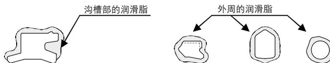
图3 向密封圈涂抹润滑脂
