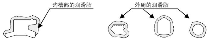
图3 向密封圈涂抹润滑脂
