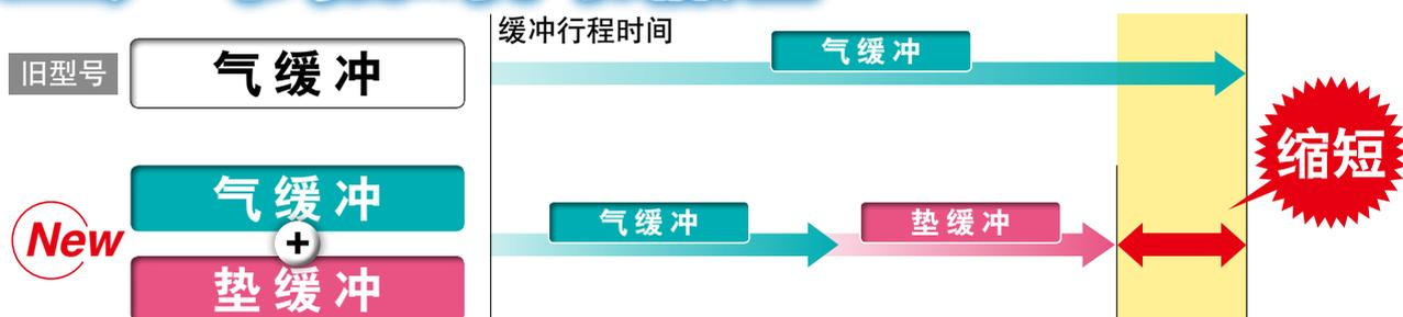
■ 垫缓冲使活塞停止时的金属噪音减小
