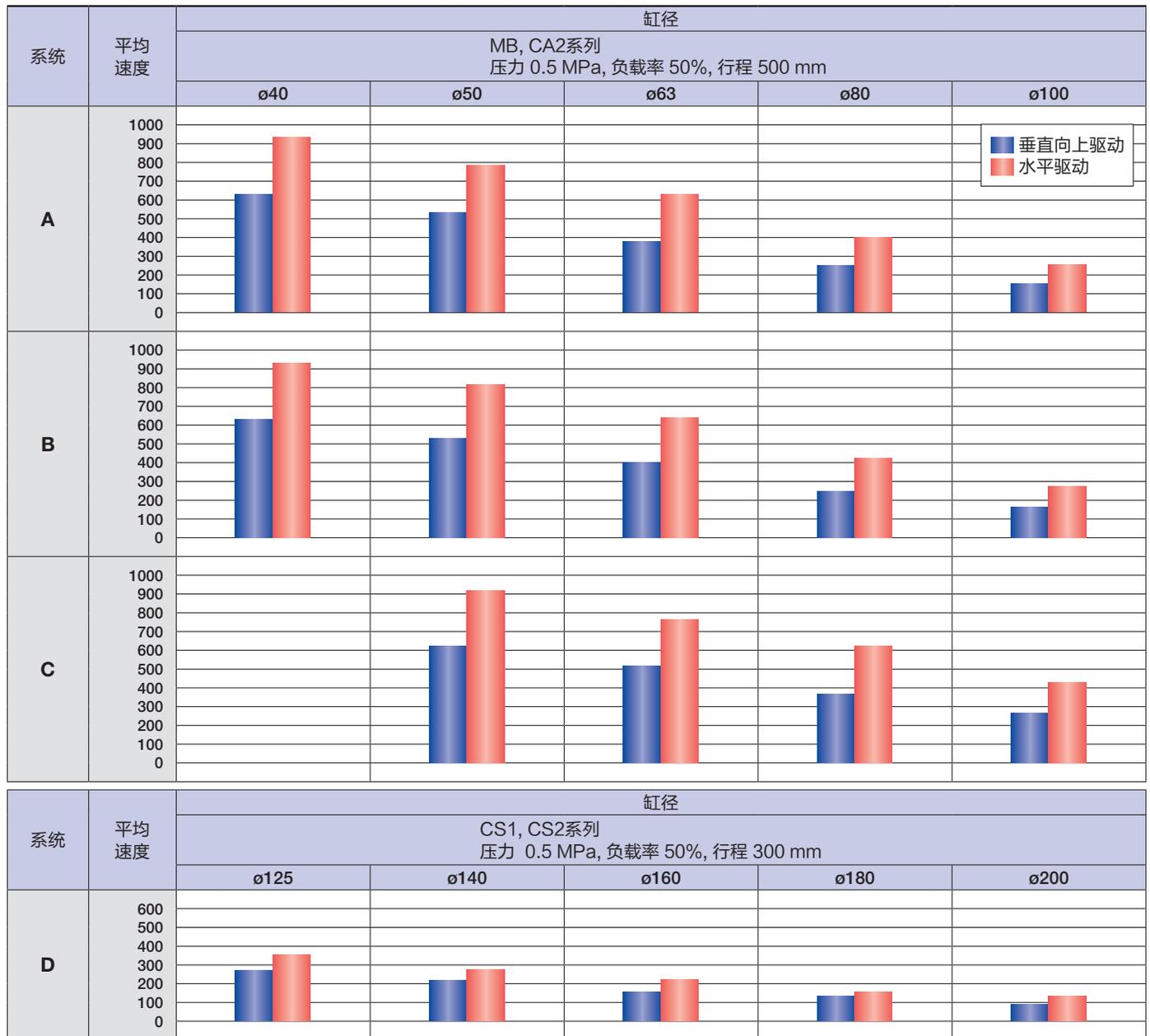
※气缸伸出时，通过排气节流阀来控制速度，与气缸直接连接且针阀全开的场合。
