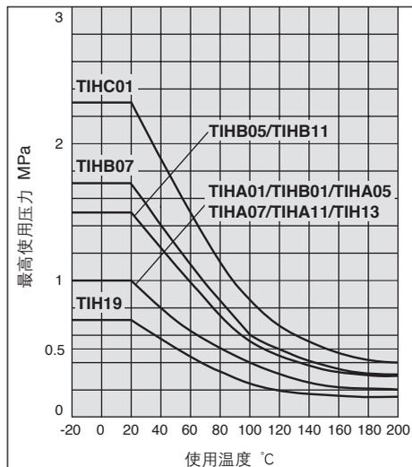
注)外径尺寸相同,内径尺寸不同,最高使用压力也会不同。
