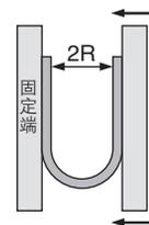
温度20°C的条件下, 管子弯曲成U字形, 一端固定另一端慢慢靠近, 管子上出现皱折、压坏等时, 测定2R。
