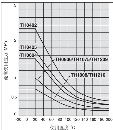
注)外径尺寸相同,内径尺寸不同,最高使用压力也会不同。
