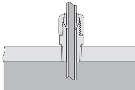
管子贯通型卡套式接头的使用范围
