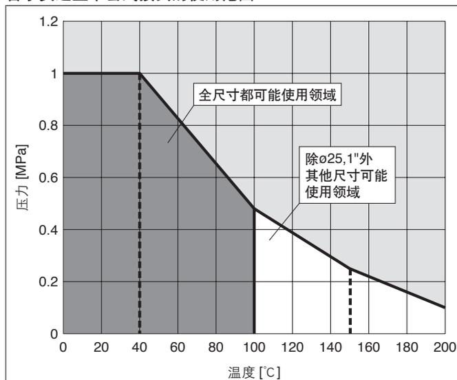
管子贯通型卡套式接头的使用范围
