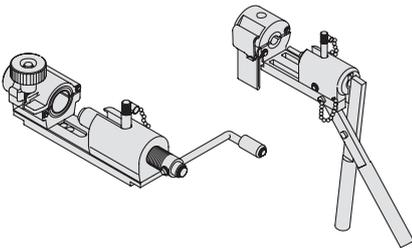
② 螺母紧固至接头体端面为止。大致可参见下记适合的紧固力矩。
