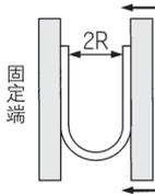
温度20°C的条件下,把管子U字形弯曲,一端固定,另一端慢慢与其靠近,管子弯曲部的外径变化率达到5%时,测定2R。
