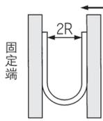
温度20°C的条件下,把管子U字形弯曲,一端固定,另一端慢慢与其靠近,管子弯曲部的外径变化率达到5%时,测定2R。
