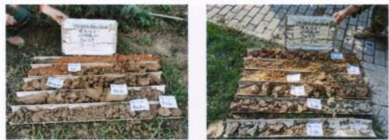
图 4 监测井现场钻遇地层岩芯展示
