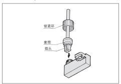
将上部带套筒的插头插到磁性开关上并插到底,再拧入锁紧环。 (不要用钳子等之类的工具拧。)
