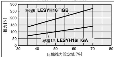
〈压触推力设定值—推力图〉
