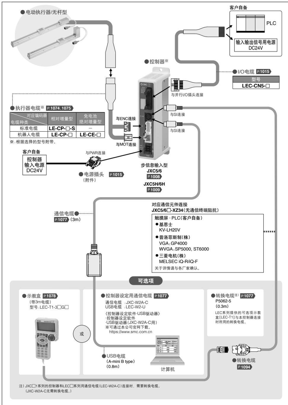
系统构成图 / 通用 I/O
