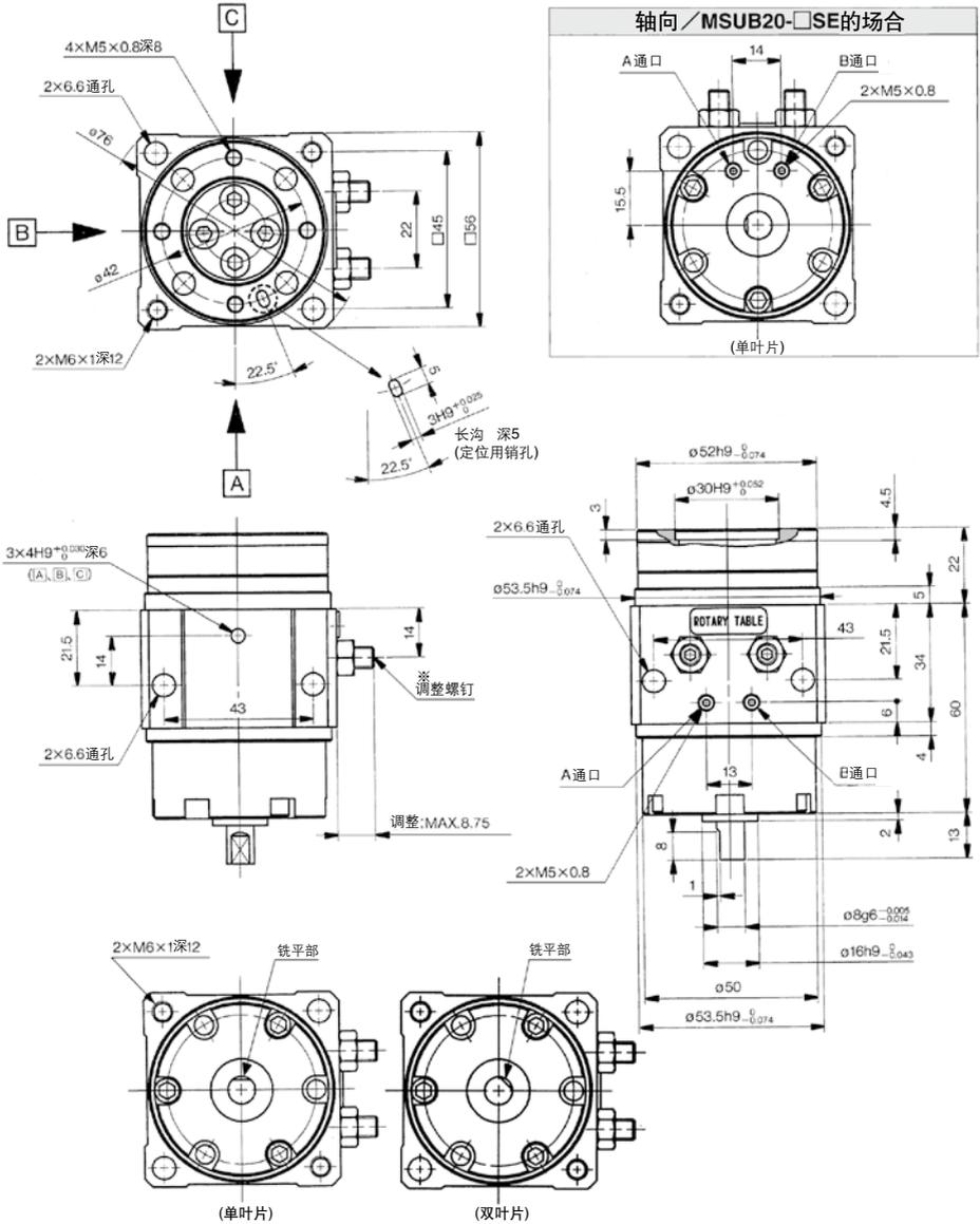
外观图把单叶片作为主体。上图表示单叶片、双叶片仅铁平部的位置有所不同。
