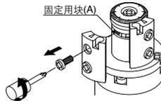
**② 安装无触点磁性开关**
