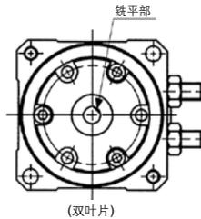
外观图把单叶片作为主体, 上图表示单叶片、双叶片仅铣平部的位置有所不同。
