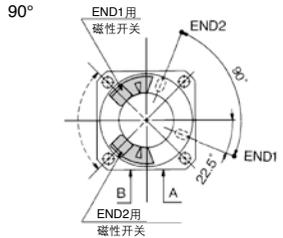
●在表示摆动范围的图上，实线90°(180°)的箭头表示台面上的定位用销孔的摆动范围，销孔在END1の場合，END1用磁性开关动作，销孔在END2の場合，END2用磁性开关动作。
