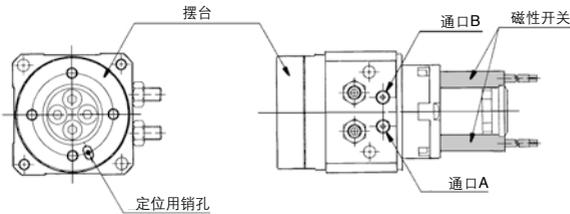
**MSU□1 · 3磁性开关安装方法****磁性开关单元的外观形状及零部件名称**
