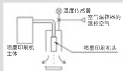
喷嘴印刷机头 防止印刷机的油墨阻塞
