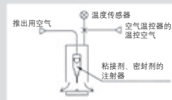
注射式的粘接剂、密封剂 粘接剂·密封剂的涂布量、IC封装剂的充填量均匀
