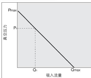
流量特性表示真空发生器的真空压力与吸入流量的关系,若吸入流量变化,则真空压力也变化。一般表示真空发生器标准使用压力时的关系。下图中, $P_{max}$ 为最高真空压力, $Q_{max}$ 为最大吸入流量。
