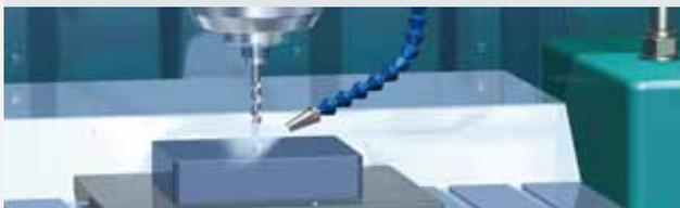
利用VX2,VQ20/30控制压缩空气的通断对钻头进行吹气
