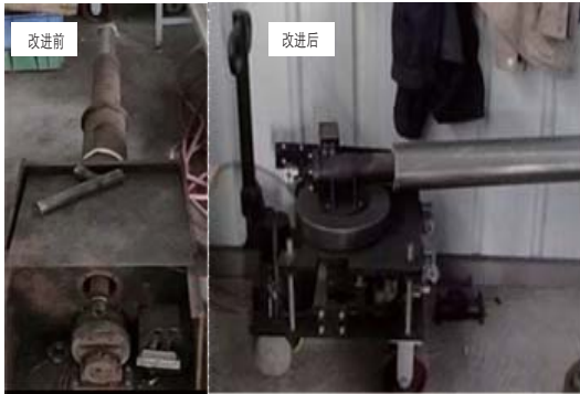
原始设备: 减速机执行机构 现设备: 气动执行机构
